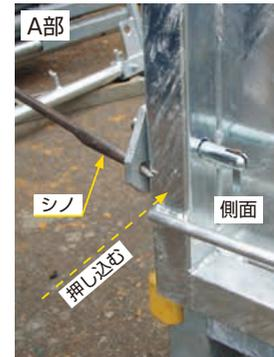
側面を開ける際にLピンが抜きにくい時は、シノ等で押し込む様にして下さい。
